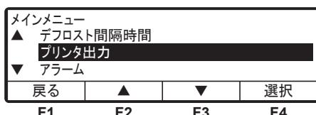
2 「F4スイッチ(選択)」を押し、「プリンタ出力モード」(右図)に切り換えます。
