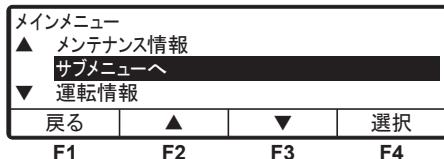
3 「F4 スイッチ(選択)」を押し、「LCD バックライト設定モード」(右図)に切り換えます。
