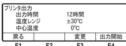
3 「F3スイッチ(変更)」を押し、出力時間を選択します。
