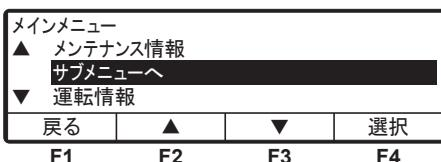
3 「F4スイッチ(選択)」を押し、「サブメニュー」(右図)に切り換えます。
