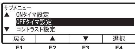
4 「F4 スイッチ(選択)」を押し、「OFF タイマ設定モード」(右図)に切り換えます。
