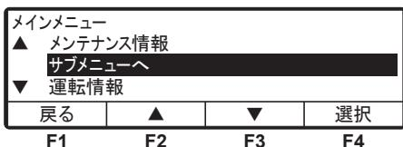
3 「F4 スイッチ(選択)」を押し、「サブメニュー」に切り換え、「LCD バックライト設定」(右図)に切り換わるまで、「F2 スイッチ(▲)」又は「F3 スイッチ(▼)」を押します。
