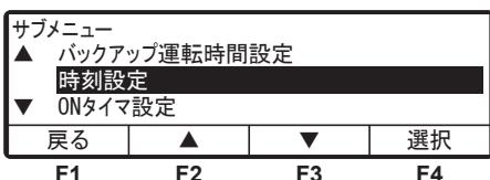
4 「F4 スイッチ(選択)」を押し、「時刻設定モード」(右図)に切り換えます。
