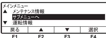
3 「F4 スイッチ(選択)」を押し、「サブメニュー」に切り換え、「ON タイマ設定」(右図)に切り換わるまで、「F2 スイッチ(▲)」又は「F3 スイッチ(▼)」を押します。
