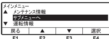
3 「F4 スイッチ(選択)」を押し、「サブメニュー」に切り換え、「OFF タイマ設定」(右図)に切り換わるまで、「F2 スイッチ(▲)」又は「F3 スイッチ(▼)」を押します。
