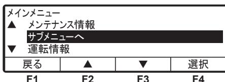
3 「F4 スイッチ(選択)」を押し、「サブメニュー」に切り換え、「バックアップ運転時間設定モード」(右図)に切り換わるまで、「F2 スイッチ(▲)」又は「F3 スイッチ(▼)」を押します。
