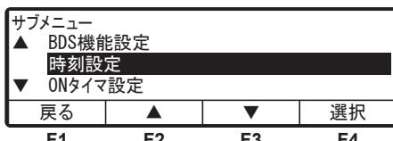
4 「F4スイッチ(選択)」を押し、「時刻設定モード」(右図)に切り換えます。
