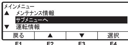
3 「F4スイッチ(選択)」を押し、「サブメニュー」(右図)に切り換えます。
