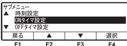
4 「F4 スイッチ(選択)」を押し、「ON タイマ設定モード」(右図)に切り換えます。
