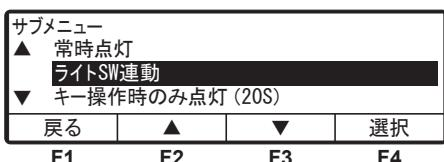
**【ライトSW運動】** : 車両のライト点灯時に連動して点灯します。
