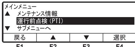
4 「F4 スイッチ(選択)」を押し、「運行前点検(PTI)選択モード」(右図)に切り換えます。
